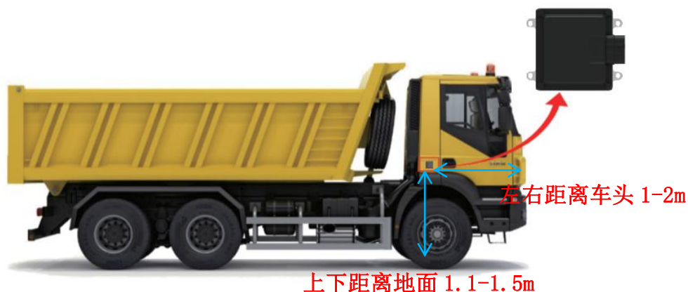
图 5.3 雷达安装示意图
