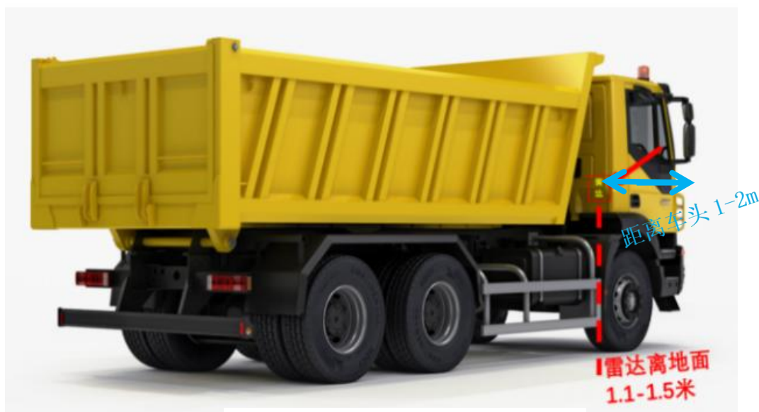
图 5.2 雷达安装侧视图
