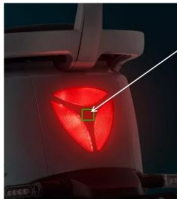
雷达PCBA模组 和尾灯整合设计在一起。
